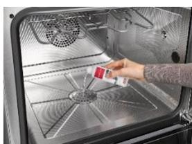
**Photo 4 :** Un détergent en liquide spécialement développé par Miele est versé dans le filtre situé sur le fond de l'appareil. De l'eau propre y est ajoutée automatiquement, puis le mélange est pompé jusqu'à la voûte avant d'être vaporisé uniformément dans le four à l'aide d'une turbine. (Photo : Miele)
